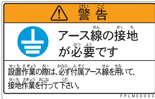
F 1 5 接地警告ラベル
