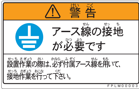
F 1 5 接地警告ラベル
