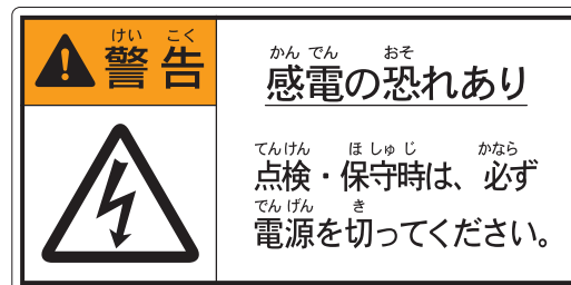
F 8 感電警告点検ラベル
