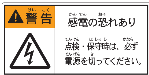
F 9 感電警告点検ラベル
