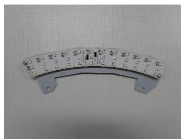
C 8 リングライトLED基板 (金具付)
