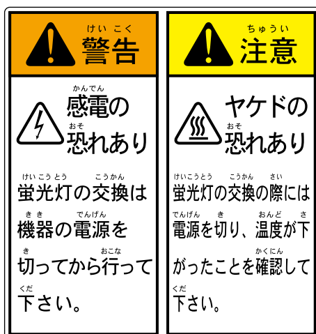
F 3 蛍光灯注意ラベル（横）
