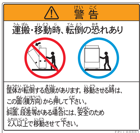
F 5 転倒警告ラベル
