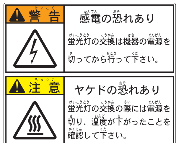
F 4 蛍光灯注意シール
