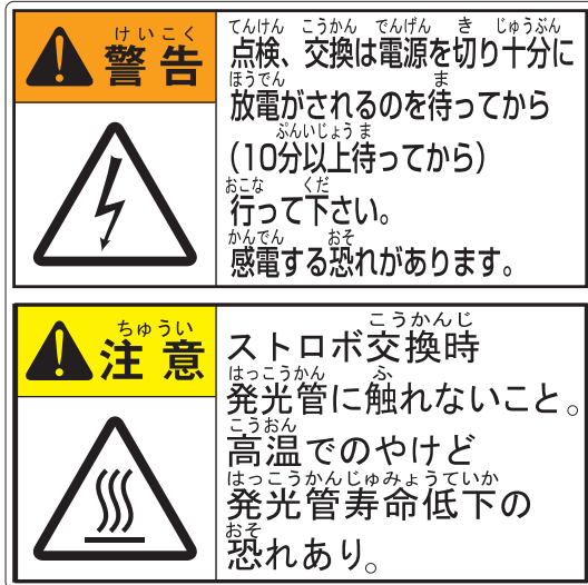
F 1 点検警告ストロボ交換 注意シール（縦）
