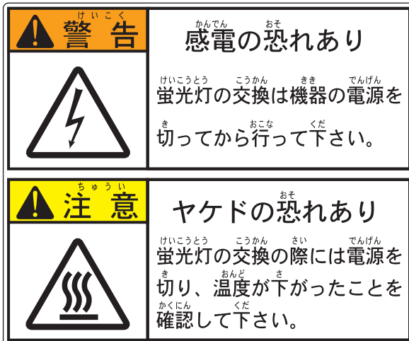
F 3 蛍光灯注意シール
