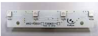
C 5 5 カメラ周囲L E D基板 ( 4 灯 )
