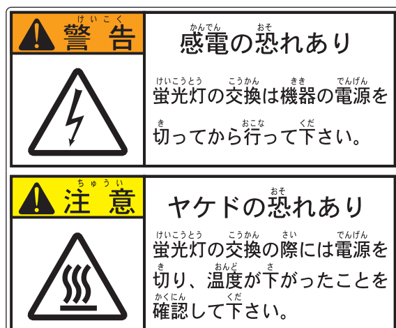
F 3 蛍光灯注意シール
