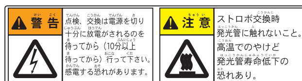
F 4 点検警告ストロボ交換注意シール
