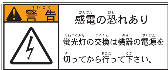
F 4 蛍光灯感電警告シール
