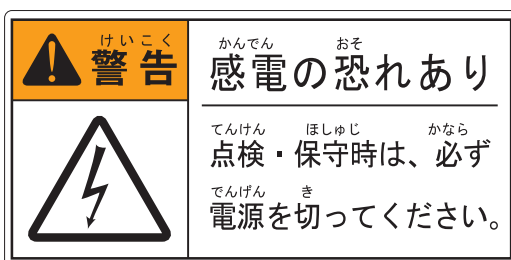
F 9 感電警告点検シール
