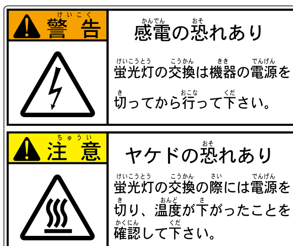
F 4 蛍光灯注意シール
