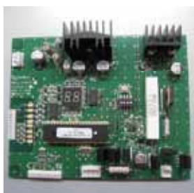
C 5 5 カーテン制御基板
